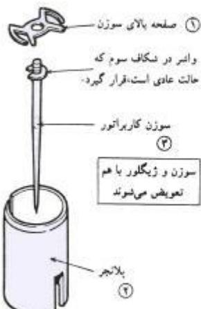
روش تعویض سوزن و زیگلور آن
